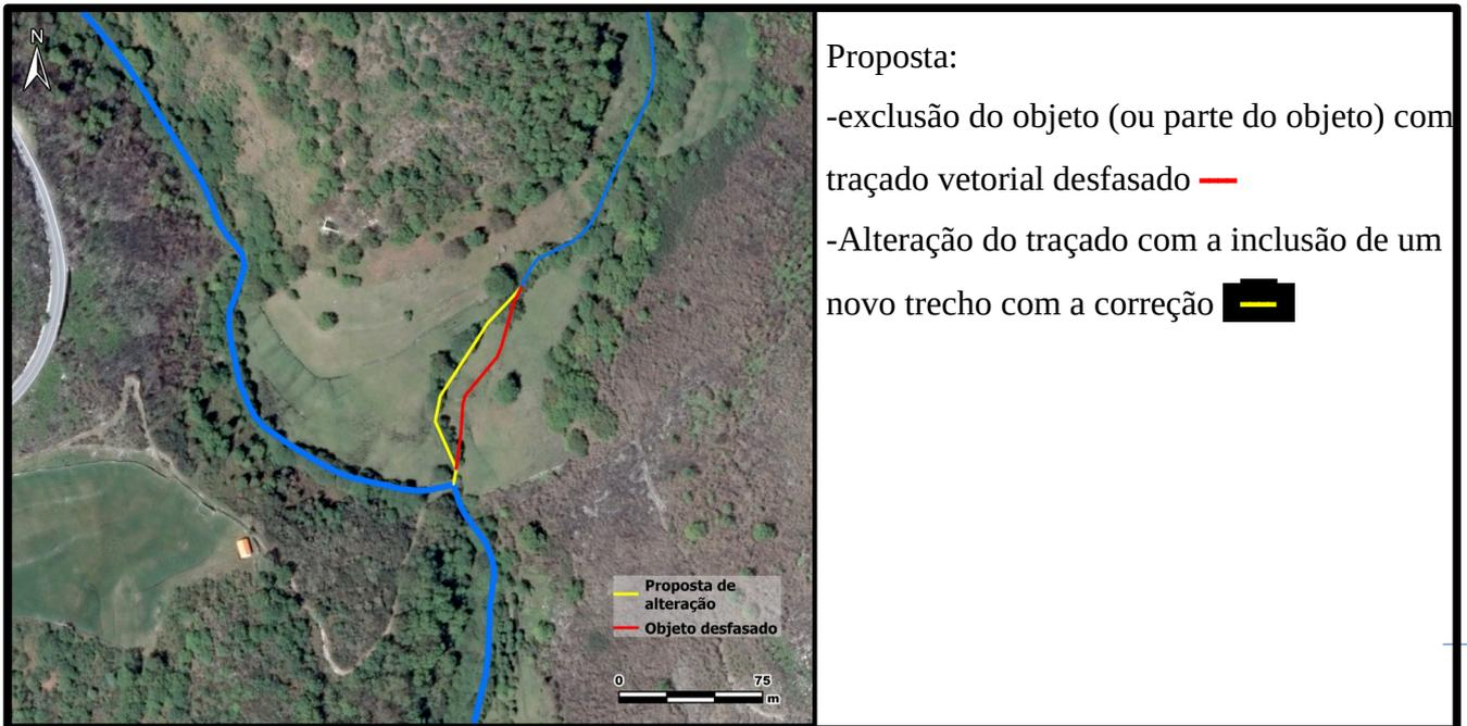
Figura 7. Exemplo de objeto com traçado vetorial desfasado.
